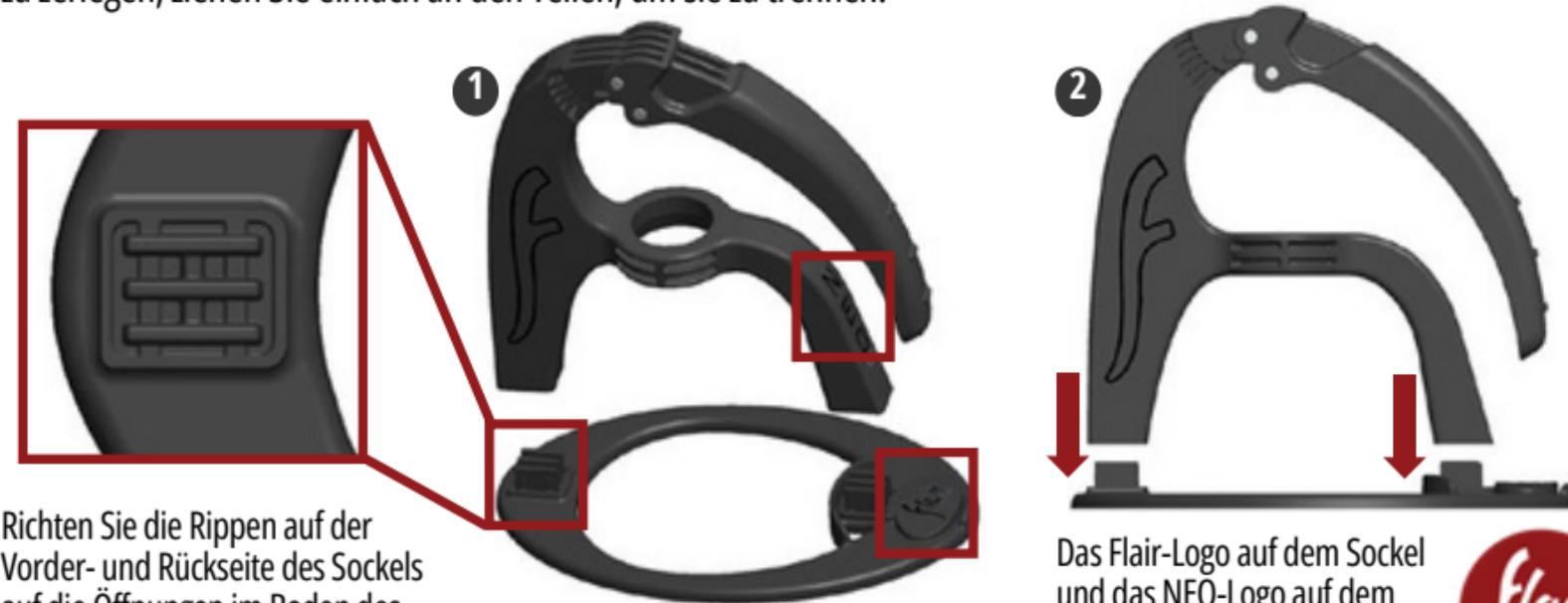
Richten Sie die Rippen auf der Vorder- und Rückseite des Sockels auf die Öffnungen im Boden des Pfostens aus. Zum Einsetzen nach unten drücken.
