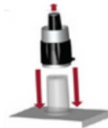
Entfernen Sie den Kolben mit Hilfe des Dosierbechers. Setzen Sie den Zylinder auf den Dosierbecher und drücken Sie ihn auf eine harte Unterlage.
