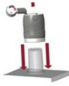
4 Retire el pistón utilizando el vaso dosificador. Coloque el cilindro sobre el vaso dosificador y presione hacia abajo.
