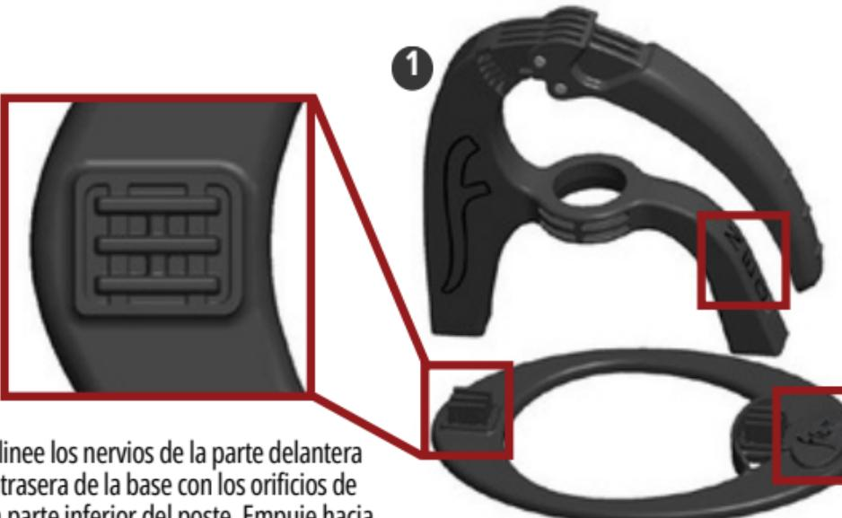
Alinee los nervios de la parte delantera y trasera de la base con los orificios de la parte inferior del poste. Empuje hacia abajo para asentar la base.
