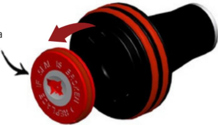
\*Retire la válvula dañada tirando de ella por la pequeña depresión del borde de la válvula. Vuelva a colocar la válvula nueva introduciéndola en el orificio de la parte inferior del pistón con la lámina hacia fuera.
