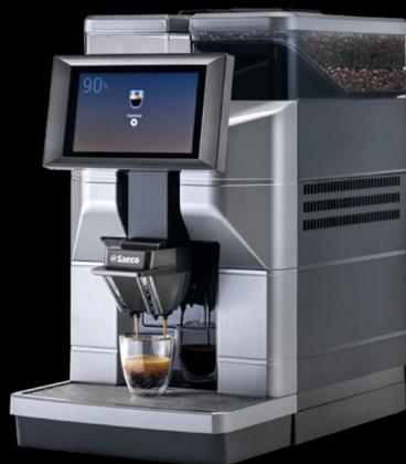
Il cuore di Magic è un gruppo professionale a camera variabile che può contenere da 8,5 fino a 15 gr di caffè; la regolazione della quantità di polvere di caffè è gestibile automaticamente dal menu della macchina. Al gruppo sono abbinati macine coniche in acciaio, anch'esse regolabili per raggiungere il grado di macinatura ottimale.
