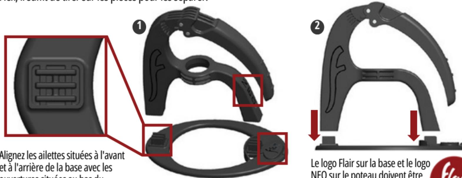
Alignez les ailettes situées à l'avant et à l'arrière de la base avec les ouvertures situées au bas du poteau. Pousser vers le bas pour le mettre en place.
