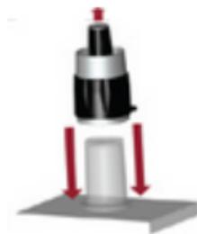
Retirez le piston en utilisant le gobelet doseur. Placez le cylindre sur le gobelet doseur et appuyez sur une surface dure.
