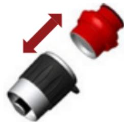
Détacher le portafiltre au-dessus de l'évier en saisissant le portafiltre d'une main et le silicone sur le cylindre d'infusion de l'autre main et en tirant.
