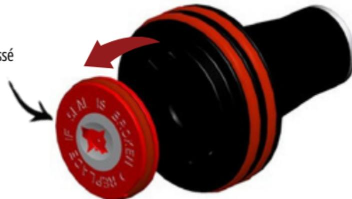
\*Retirer la valve cassée en la tirant par le petit renforcement sur le bord de la valve. Remplacez-la en poussant la nouvelle soupape dans le creux situé sous le piston, avec la feuille tournée vers l'extérieur.
