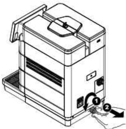
Koble slangen til vannforsyningsnettets til muffen 3/4 \* gass på automaten.
