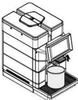
Kjør den første avkalkingsfasen. Når det er tomt for oppløsning inne i beholderen, vil maskinen be om at beholderen tømmes og skylles med rent, friskt drikkevann. Skyll beholderen godt.
