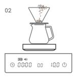
お好みの量の挽き豆をフィルターに入れます。粉の量はディスプレイに表示されます。 再度テアボタンを押します。
