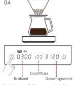
Nachdem der Brühvorgang abgeschlossen ist, stoppen Sie den Timer. Die Waage zeigt nun die Brühzeit und das Gesamtgewicht des Brühvorgangs an.
